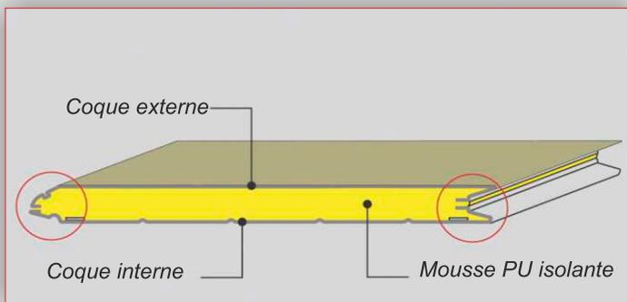
Les panneaux de nos portes sont de type « sandwich » à double coque : la surface extérieure en acier n'est pas au contact de la surface interne, ce qui évite la conduction du froid ou de la chaleur par les bords du panneau. La mousse polyuréthane de 40 mm d'épaisseur assure l'isolation sur toute la surface du panneau.
